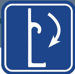
Le tende da sol L125, C125, C135 e pergola 135 sono dotate di una piastra a muro progettata per il fissaggio a incastro dal basso. La tenda si posiziona e si mantiene in modo autoportante sin dal momento dell'installazione, prima dell'avvitamento definitivo.
