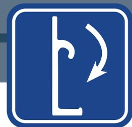
Los toldos L125, C125, C135 y pérgola 135 están equipados con una percha mural diseñada para fijarse mediante encaje desde abajo. El toldo se coloca y se mantiene de forma autoportante desde el momento de su instalación, antes del atornillado definitivo.
