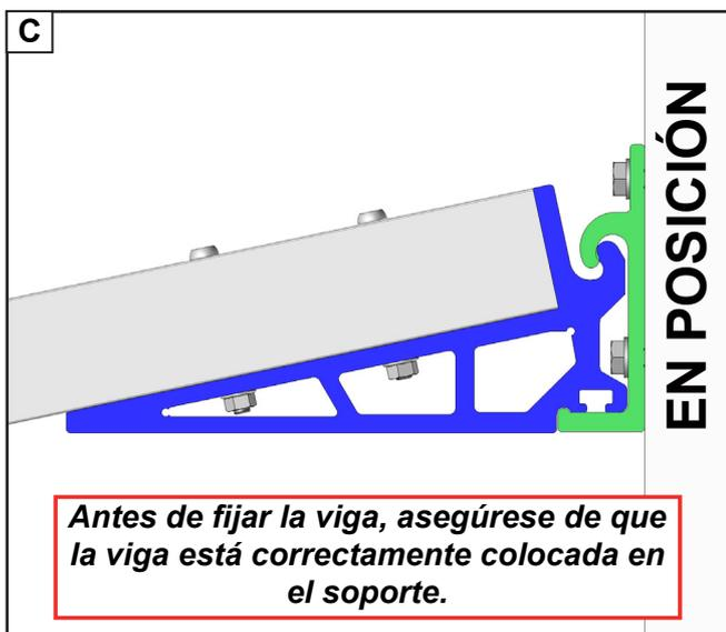
Antes de fijar la viga, asegúrese de que la viga está correctamente colocada en el soporte.
