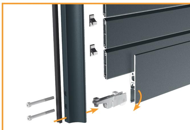
Roulement sur rail équipé de roulettes à aiguilles, offrant un réglage en hauteur de 5 mm pour faciliter l'ajustement et garantir une installation rapide et précise.
