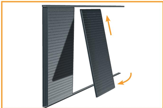
Montaje simplificado de los paneles con guía en la parte superior y apoyo estabilizado en el riel inferior.
