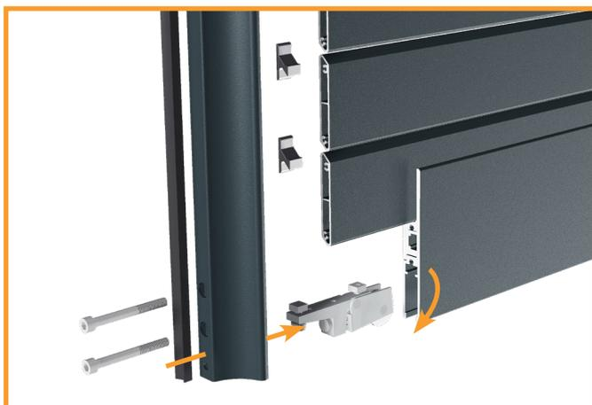
Rodamiento sobre riel equipado con ruedas de agujas, que ofrece un ajuste de altura de 5 mm para facilitar el ajuste y garantizar una instalación rápida y precisa.
