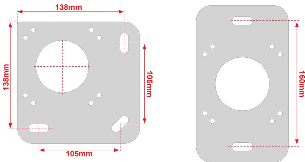
Fixez les platines au niveau de chaque plot béton réalisé.
