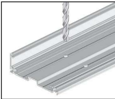
Pour les pergolas supérieures à 7m réalisez les mêmes perçages sur les deux profils muraux. Les fixations seront positionnées derrière les chevrons support de plaques.
