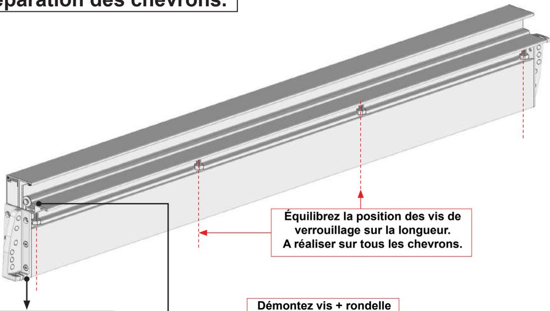
Équilibrez la position des vis de verrouillage sur la longueur. A réaliser sur tous les chevrons.
