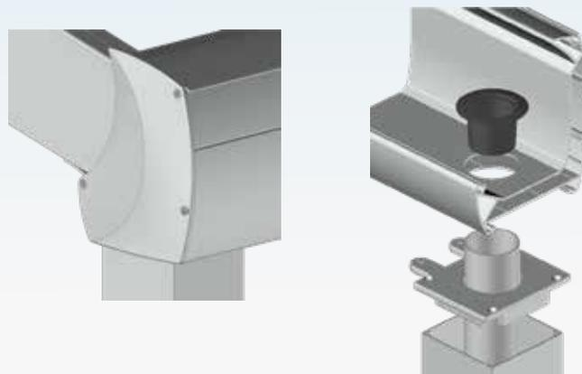
L'acqua piovana viene scaricata attraverso i tubi inseriti nei profili dei pali. La copertura del tetto in policarbonato assicura l'impermeabilità.
