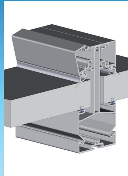
Clipper les profils de verrouillage des plaques.
