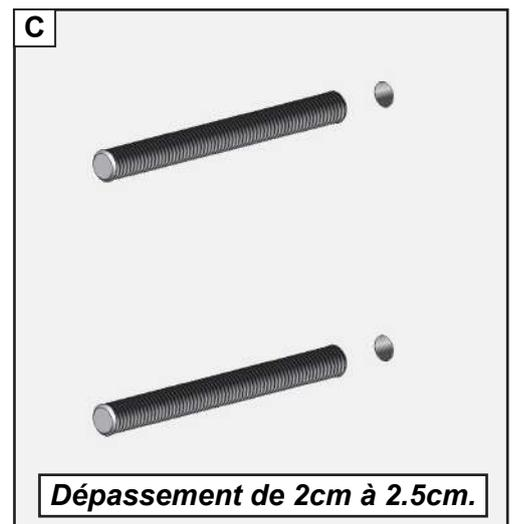
**Adattare il fissaggio al tipo di parete. Fissaggio con viti da Ø10 mm. Kit di viti e rondelle non fornite. Per l'installazione con un kit di sigillanti chimici, fare riferimento alle istruzioni per l'uso del prodotto utilizzato.**
