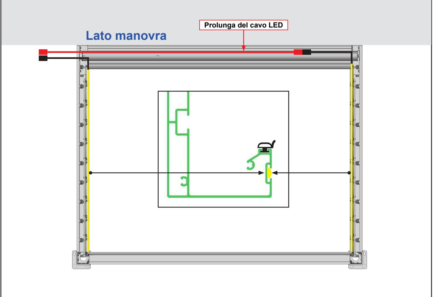
Posa di strisce LED sul profilo anteriore. Solo opzione LED.
