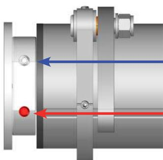
Vite di regolazione dell'apertura della lama
