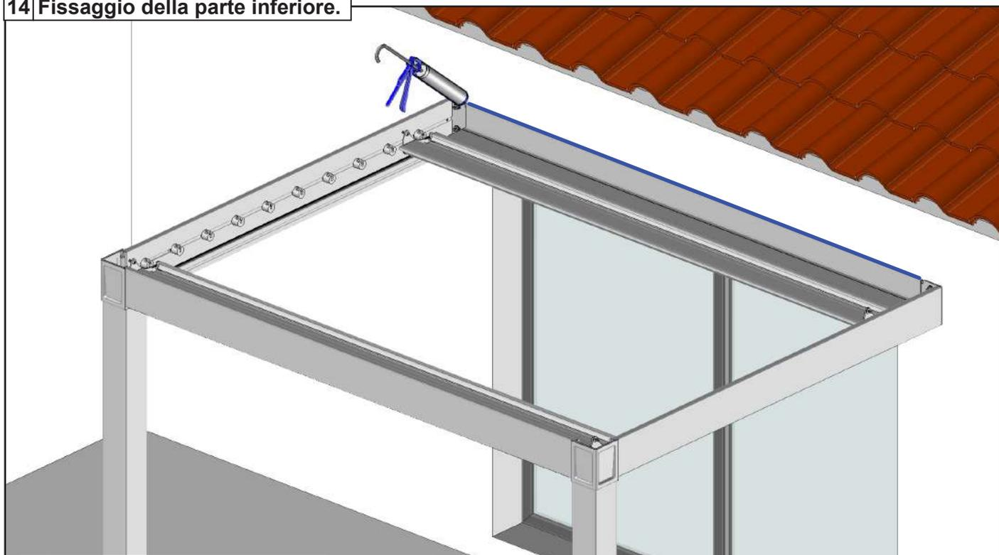
A Fissare la parte inferiore.
