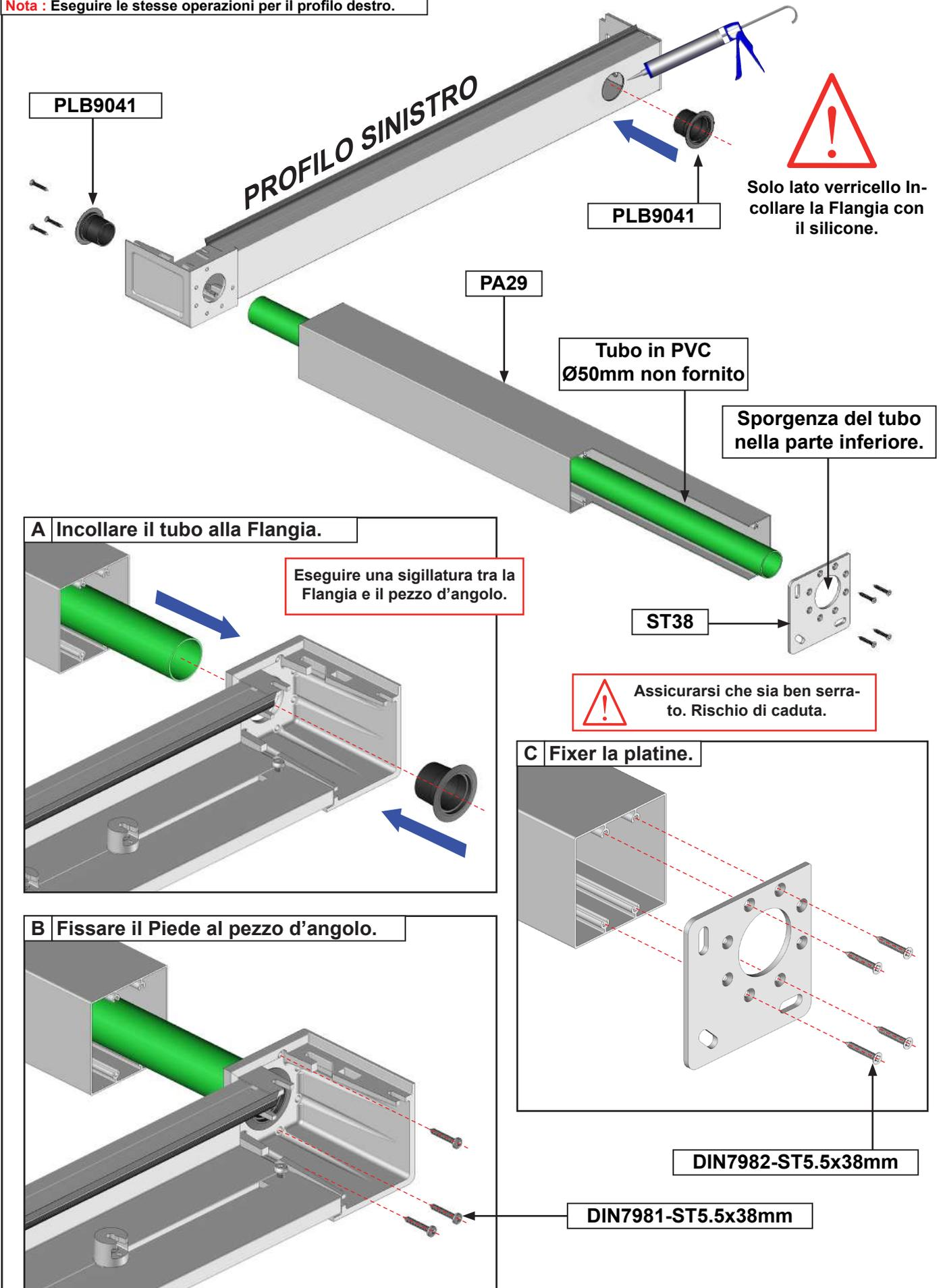
**Assemblaggio del profilo anteriore e posteriore del cassonetto. Esempio di gomito di drenaggio dell'acqua.**
