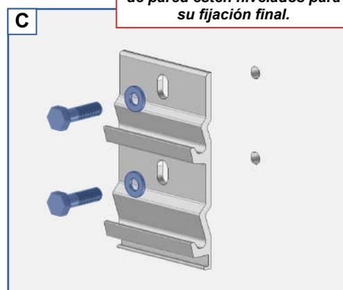
**Adapte la fijación a la naturaleza de la pared. Fijación con tornillos Ø10mm. Kit de tornillos y arandelas no incluido. En el caso de la instalación con un kit de sellado químico, consultar las instrucciones de uso del producto utilizado.**
