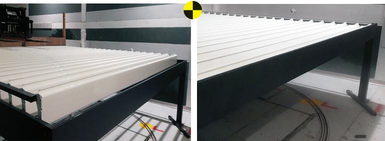
La pérgola ha sufrido impactos de viento de altas velocidades en las diferentes configuraciones de apertura / cierre. Cuando el viento actúa perpendicularmente en las lamas estas sufren mucha más presión y las vibraciones pueden alcanzar niveles altos. No se observó fragilidad de las lamas ni de sus fijaciones en el resultado de estas pruebas.
