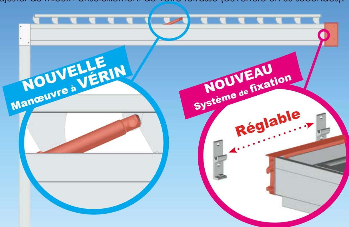
Le vérin nous permet de manœuvrer un tablier pouvant aller jusqu'à 20m<sup>2</sup> (4m x 5m) grâce à sa force de 2400N. Il est totalement intégré dans la poutre latérale afin d'être rendu invisible lorsque les lames sont fermées. Sa fixation est réalisée par deux pièces coulissant dans la poutre et dans le profil de manœuvre (aucune mécanisation).
