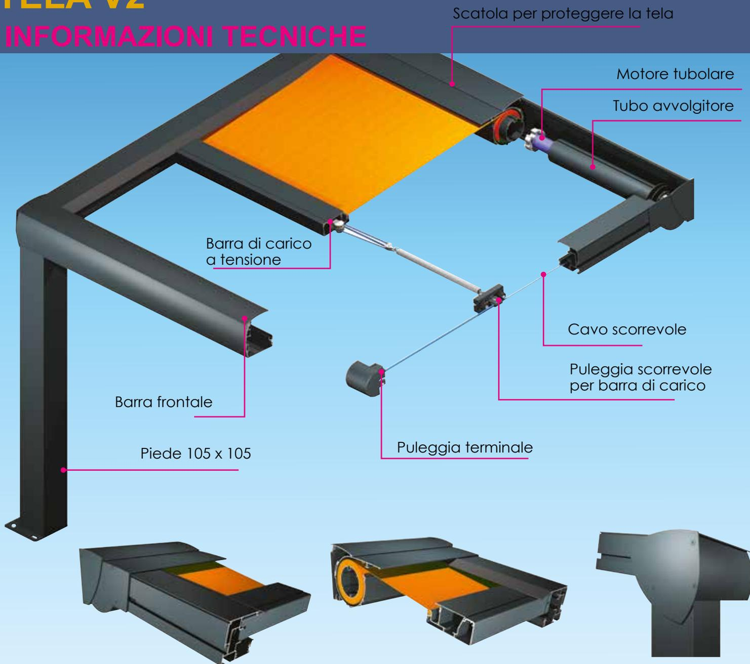
Arrotolamento del tessuto con il tubo e motore cablato (telecomando opzionale e o illuminazione a LED)
