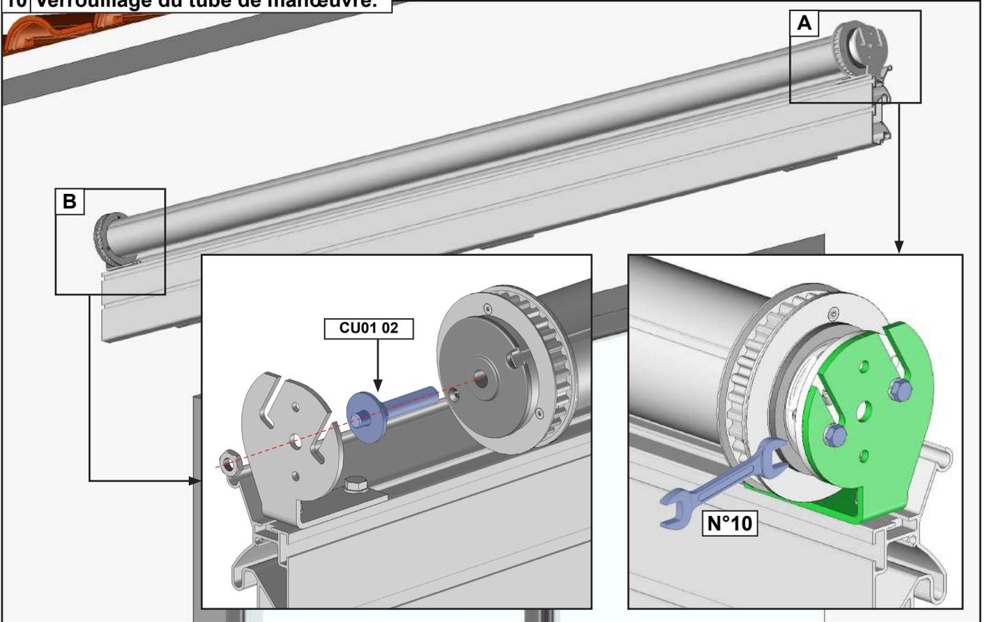
**11 Verrouillage des supports tube de manœuvre.**
