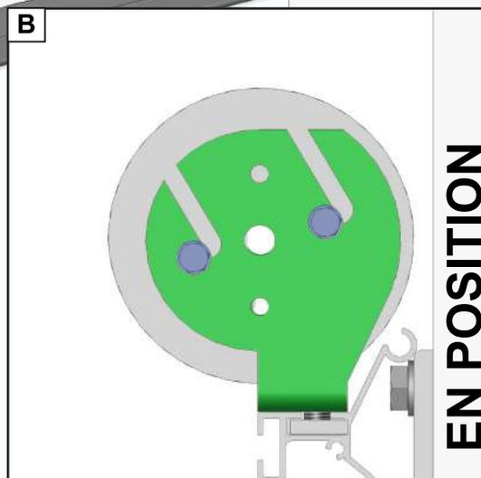
**10 Verrouillage du tube de manœuvre.**
