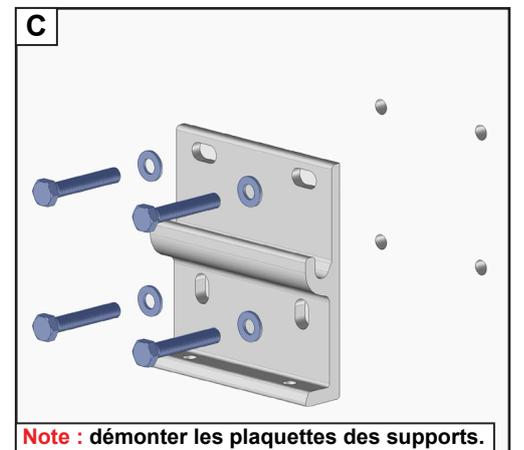
**Note :** démonter les plaquettes des supports.
