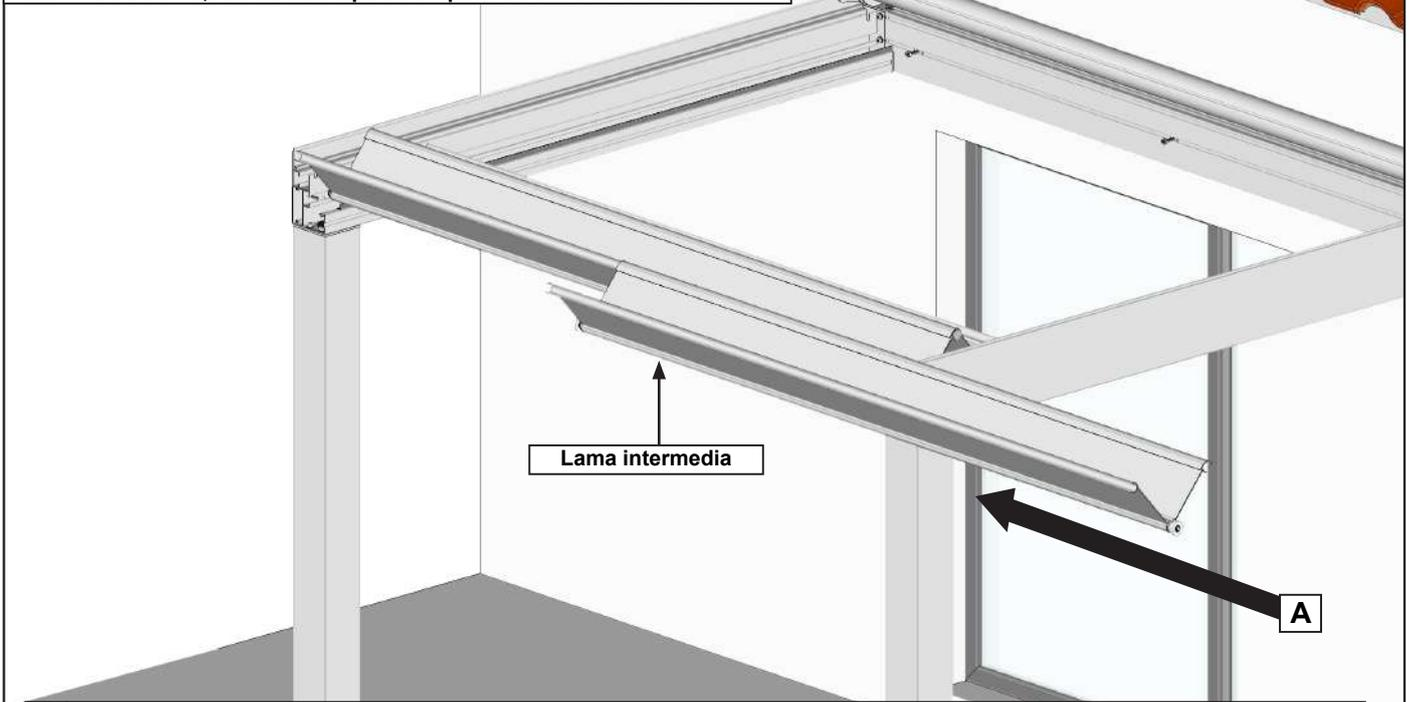
**A** Deslice la Lamas intermedia sobre los Ensamblajes Arriba.
