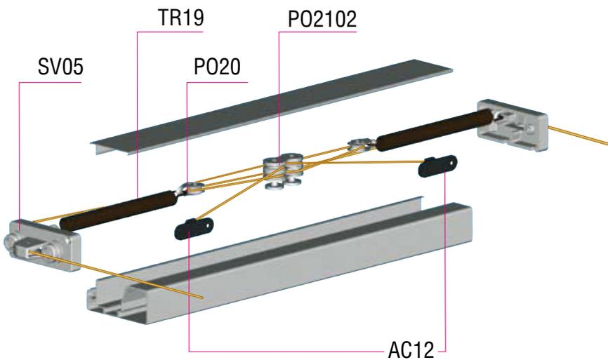
La barra delantera integra el mecanismo que garantiza la tensión constante de la lona al enrollar como al desenrollar.
