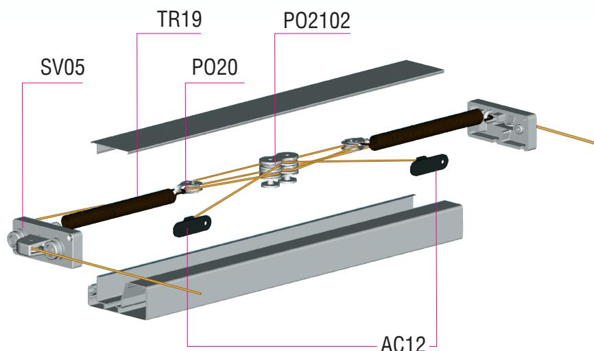
La barre de charge intègre un mécanisme qui assure la tension constante de la toile à l'enroulement comme au déroulement.
