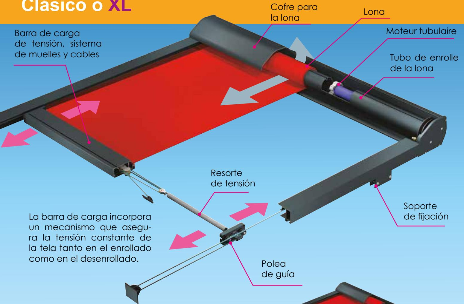
La barra de carga incorpora un mecanismo que asegura la tensión constante de la tela tanto en el enrollado como en el desenrollado.
