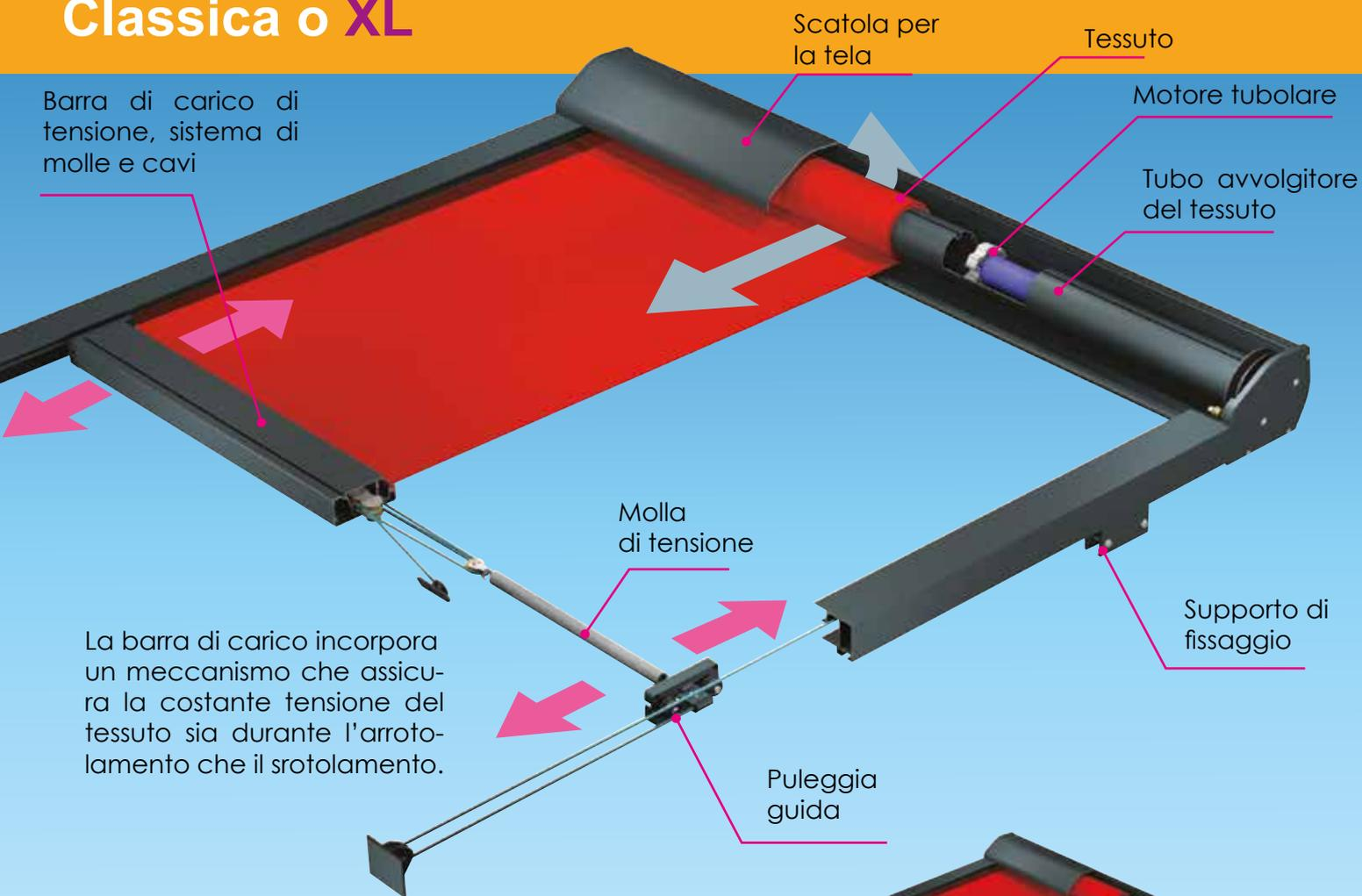
La barra di carico incorpora un meccanismo che assicura la costante tensione del tessuto sia durante l'arrotolamento che il srotolamento.
