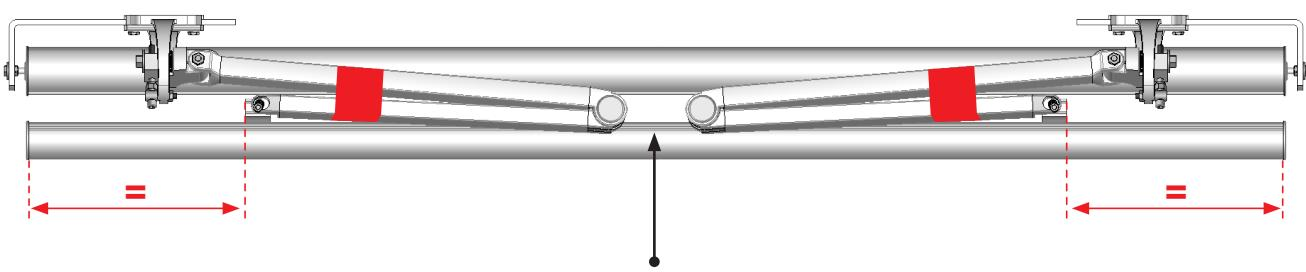
Coudes bras centrés entre le tube d'enroulement et la barre de charge
