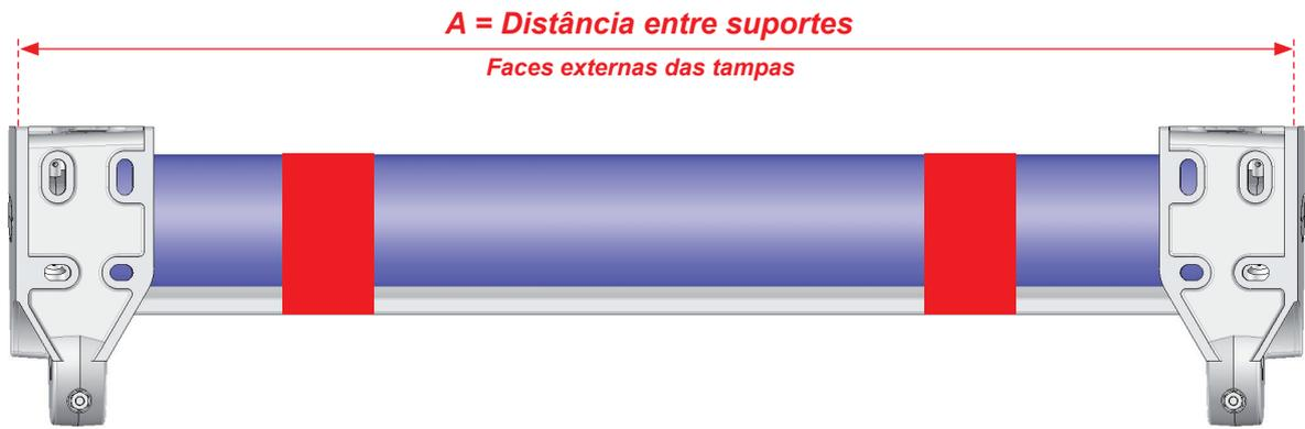
*Desmontar as tampas após fazer a medição.*
