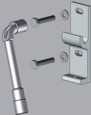
Permet d'aligner les supports au chevron d'une ossature bois
