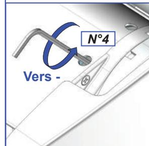
**Fin de course** : Actionner la vis vers le «+» pour plus de fermeture ou d'ouverture, vers le «-» pour moins fermeture ou d'ouverture.
